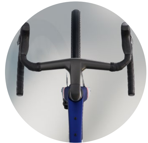
Das Cockpit des Checkmate ist oben an den Griffen drei Zentimeter schmäler als unten.
